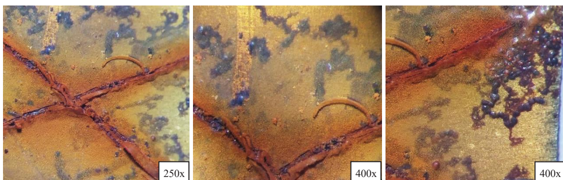
Figura 23 – Morfologia do ataque ao aço revestido pelo verniz em água do mar
