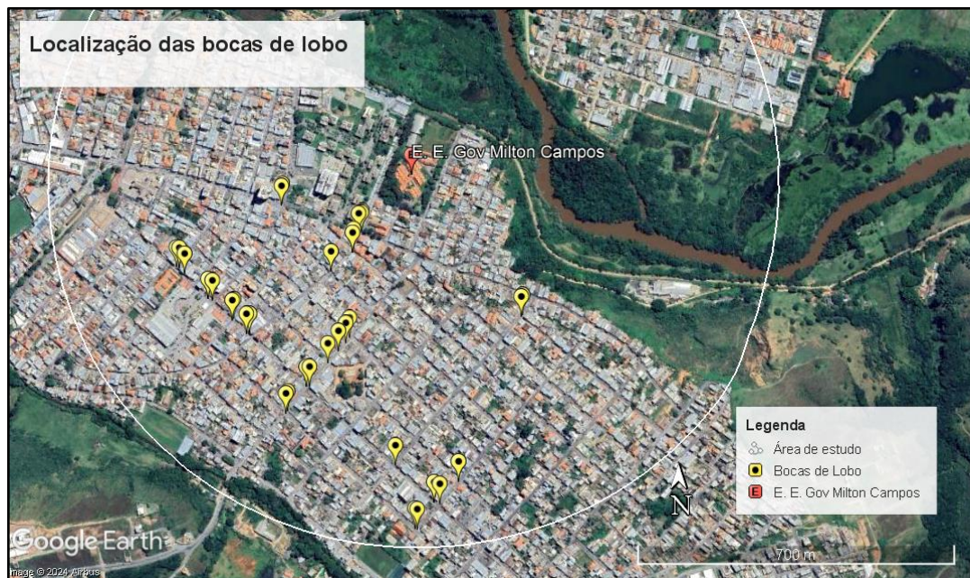
Figura 22: Localização e distribuição de bocas de lobo no Matosinhos. Fonte: Elaborado pelo autor (2023).
