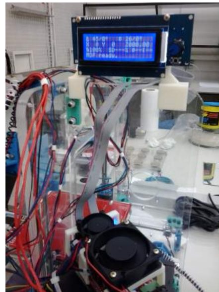
(b) Montagem final da impressora, com destaque para tela LCD.
